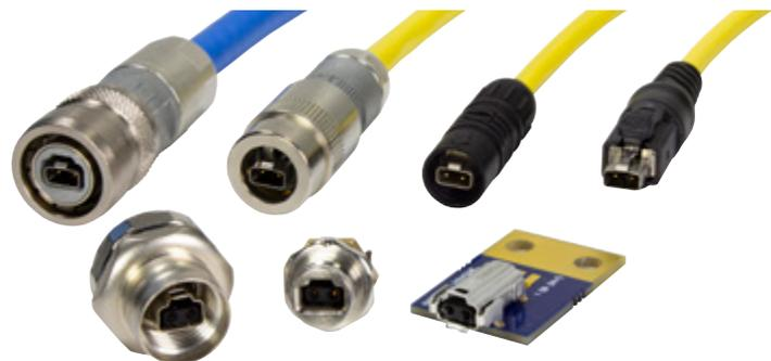
IEC 63171-6準拠のSPEモデル：IP65/67およびIP20バージョン（上段左から右へ：M12 PushPull、M8 PushPull、M8スナップイン、IP20コネクタ / 下段左から右へ：M12ソケット ねじタイプおよびPushPullインターロック付き、M8ソケット スナップインタイプおよびPushPullインターロック付き、アングル型IP20 PCBソケット）
