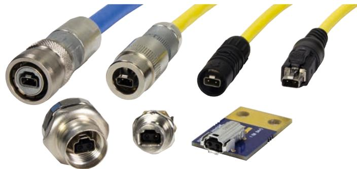
SPE-Steckverbinder-Ausführungen nach IEC 63171-6 als IP65/67 sowie als IP20 Ausführungen (obere Reihe v.l.n.r.: M12 PushPull Stvb., M8 PushPull Stvb., M8 SnapIn Stvb. und IP20 Stvb. / obere Reihe v.l.n.r.: M12 Buchse mit Schraub- und PushPull-Verriegelung, M8 Buchse mit SnapIn- und PushPull-Verriegelung, gewinkelte IP20 Leiterplattenbuchse)
