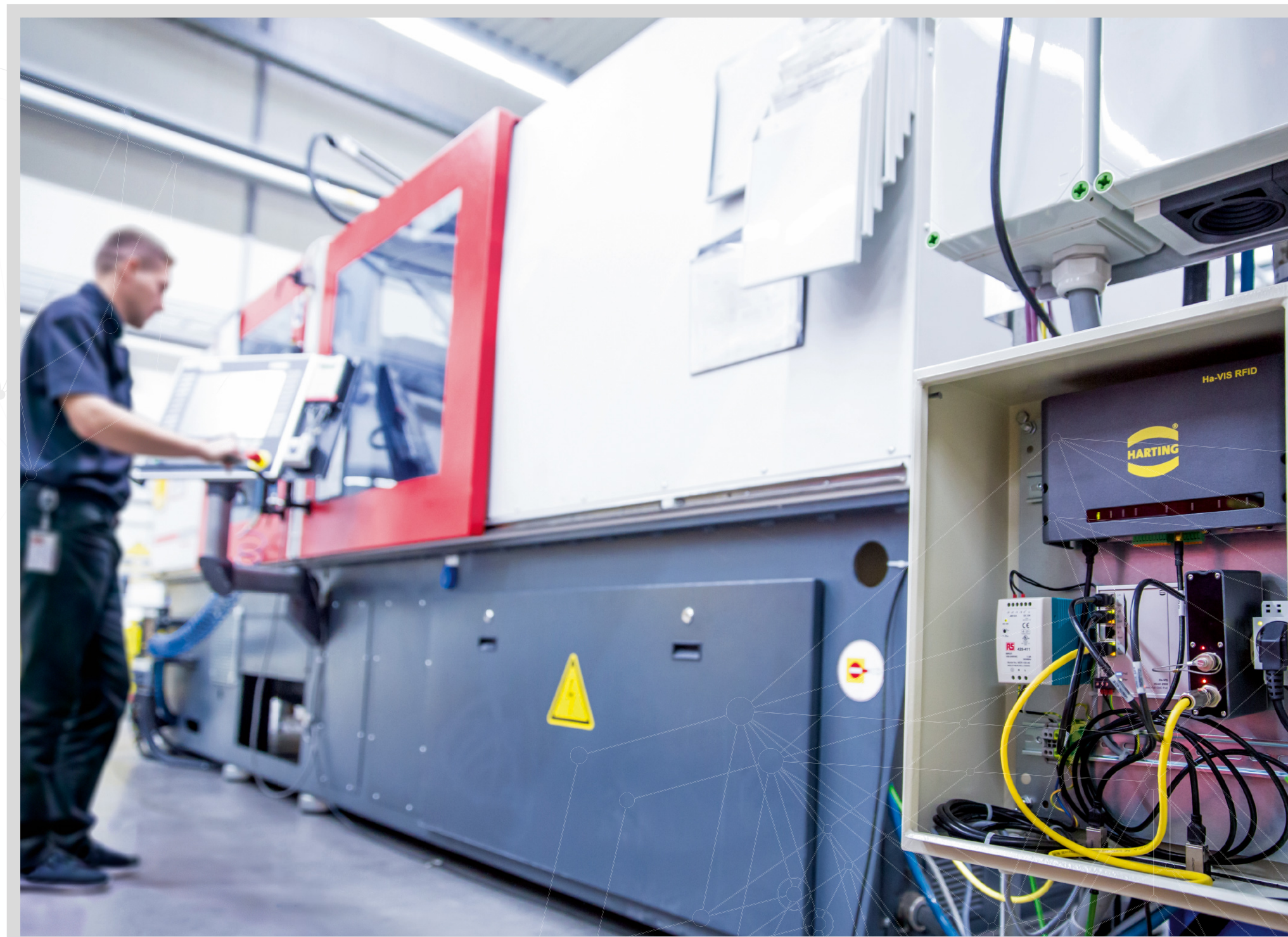
El MICA® trabajando: sistema de moldeado por inyección en
